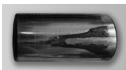
Коррозия в точках останова на роликах
