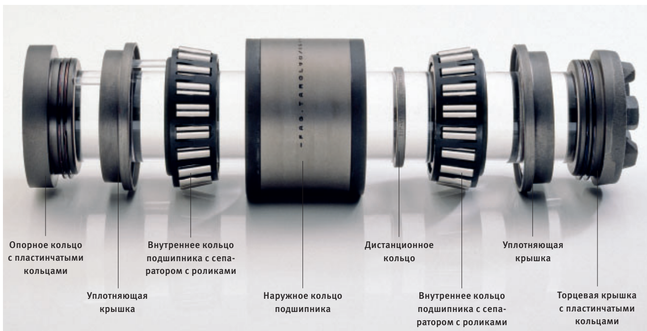
Отдельные детали узла TAROL с пластинчатыми кольцами
